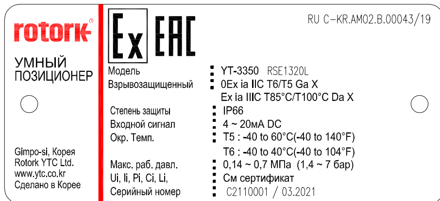
그림 L-15: YT-3350 본질안전 방폭 명판 (EAC)
